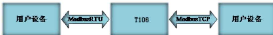
图 7 Modbus RTU 转 ModbusTCP 结构图
