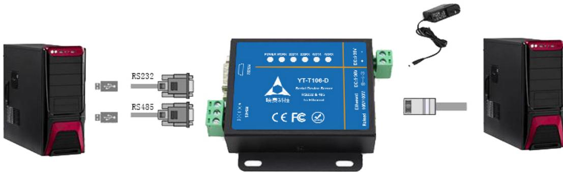
图 1 硬件连接示意图
