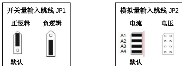
I/O 跳线端子 (JP) 和接线端子 (J1 和 J2) 的位置
